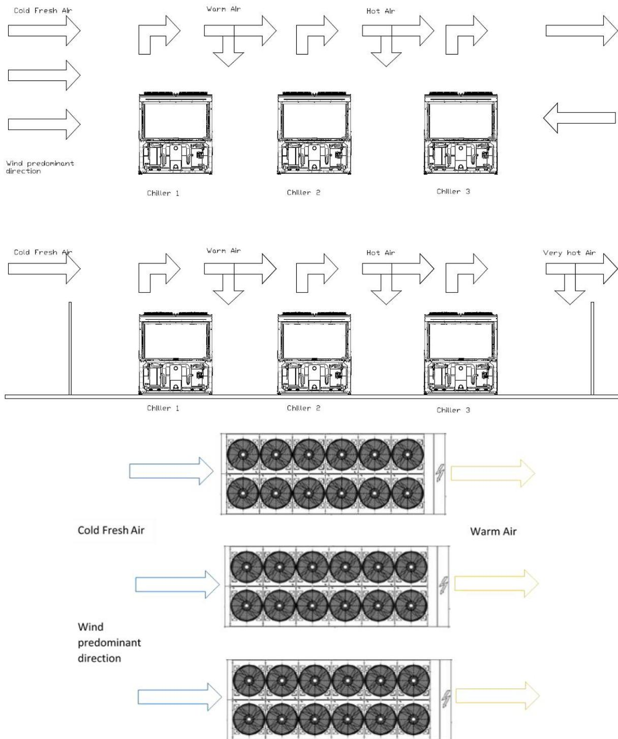
**Рис. 4. Монтаж нескольких чиллеров**
