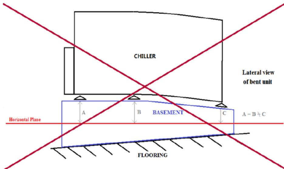
Рис. 2. Выравнивание агрегата
