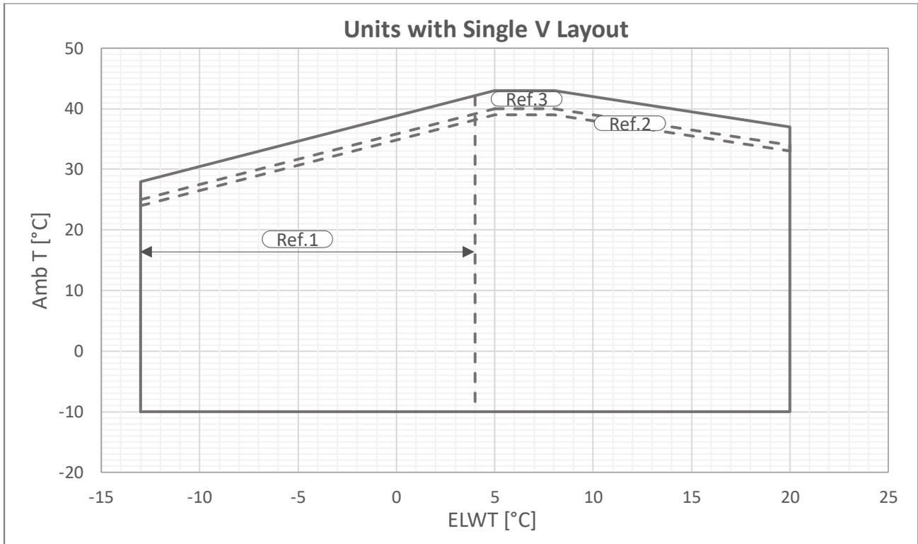
Рис. 11. Эксплуатационные пределы односекционного агрегата V-Silver
