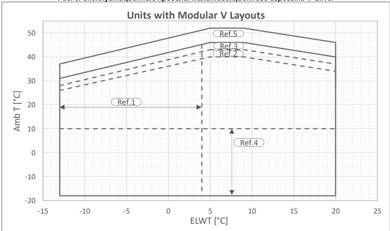
**Рис. 10. Эксплуатационные пределы мультисекционного агрегата V-Gold**
