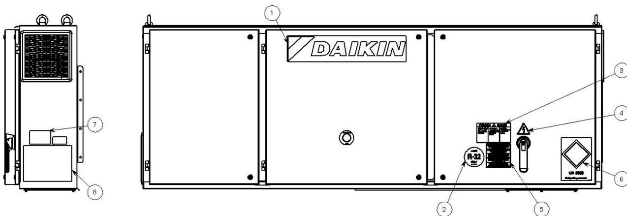
Рис. 16. Описание табличек, нанесенных на электрический щит
