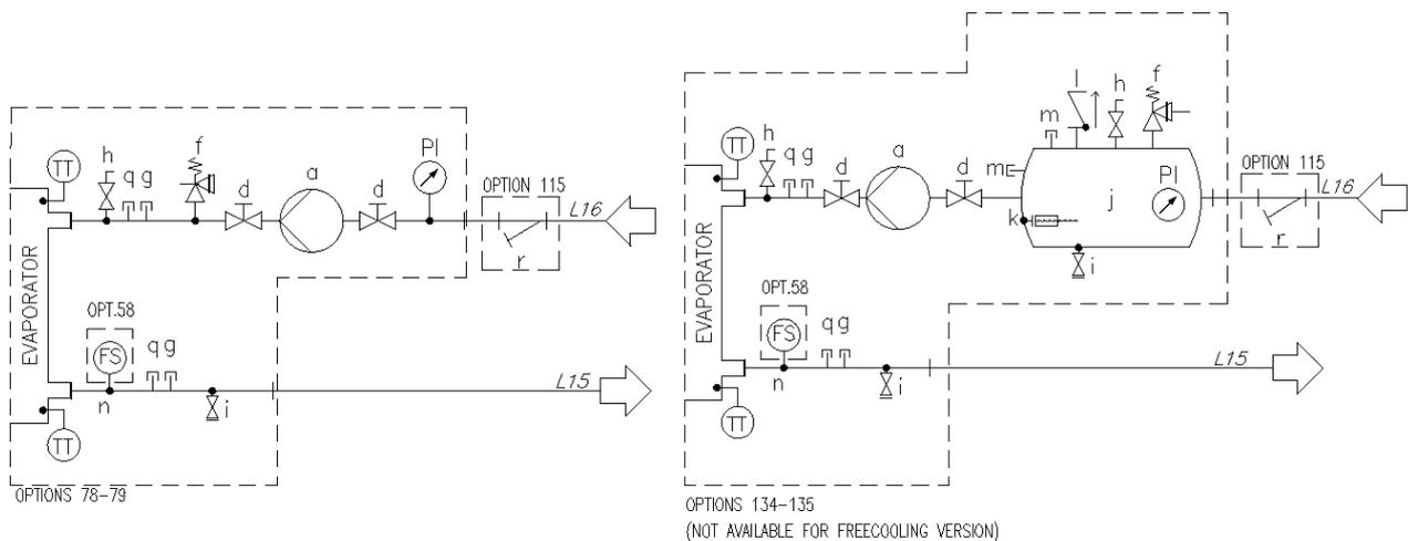
**Рис. 6. Гидравлическая схема односекционного агрегата (EWA Txx5B) с одним насосом (компл. 78-79/134-135) (макс. рабочее давление 6 бар)**
