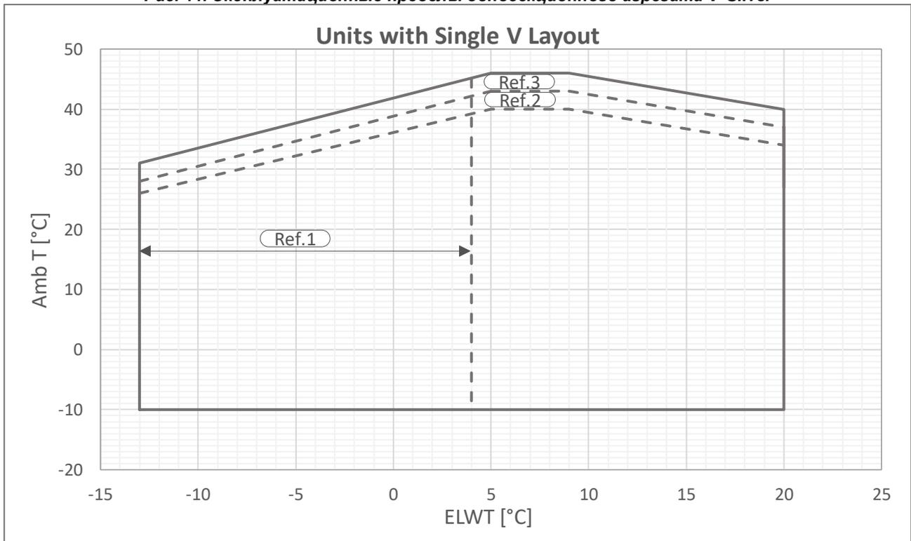
Рис. 12. Эксплуатационные пределы односекционного агрегата V-Gold
