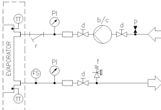
**Рис. 5. Гидравлическая схема агрегата без встроенного насоса (макс. рабочее давление 20 бар)**
