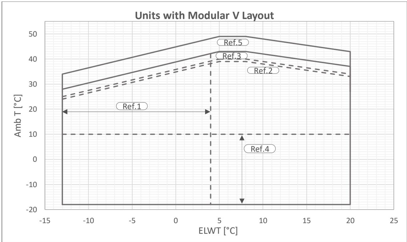
**Рис. 9. Эксплуатационные пределы мультисекционного агрегата V-Silver**
