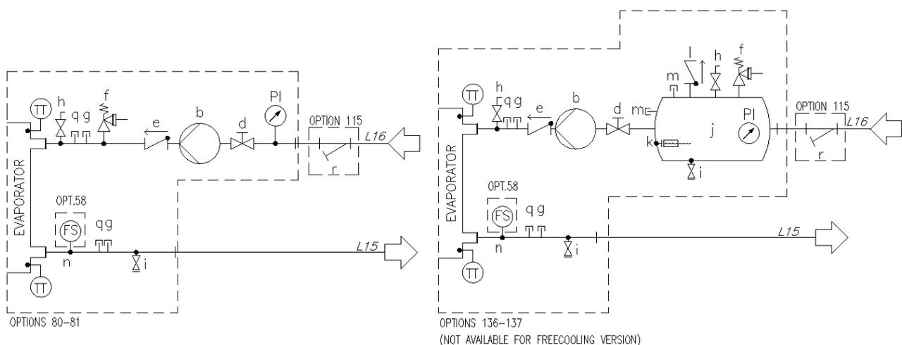
**Рис. 7. Гидравлическая схема односекционного агрегата (EWA Txx5B) со вдвоенным насосом (компл. 80-81/136-137) (макс. рабочее давление 6 бар)**
