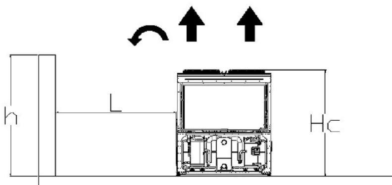
Если  $h < H_c \rightarrow L \geq 3,0$  м (мультисекционный) /  $L \geq 1,8$  м (односекционный). Если  $h > H_c$  или  $L$  меньше рекомендуемого расстояния в свету, следует обратиться к своему дистрибьютору Daikin, чтобы оценить возможные варианты размещения.
