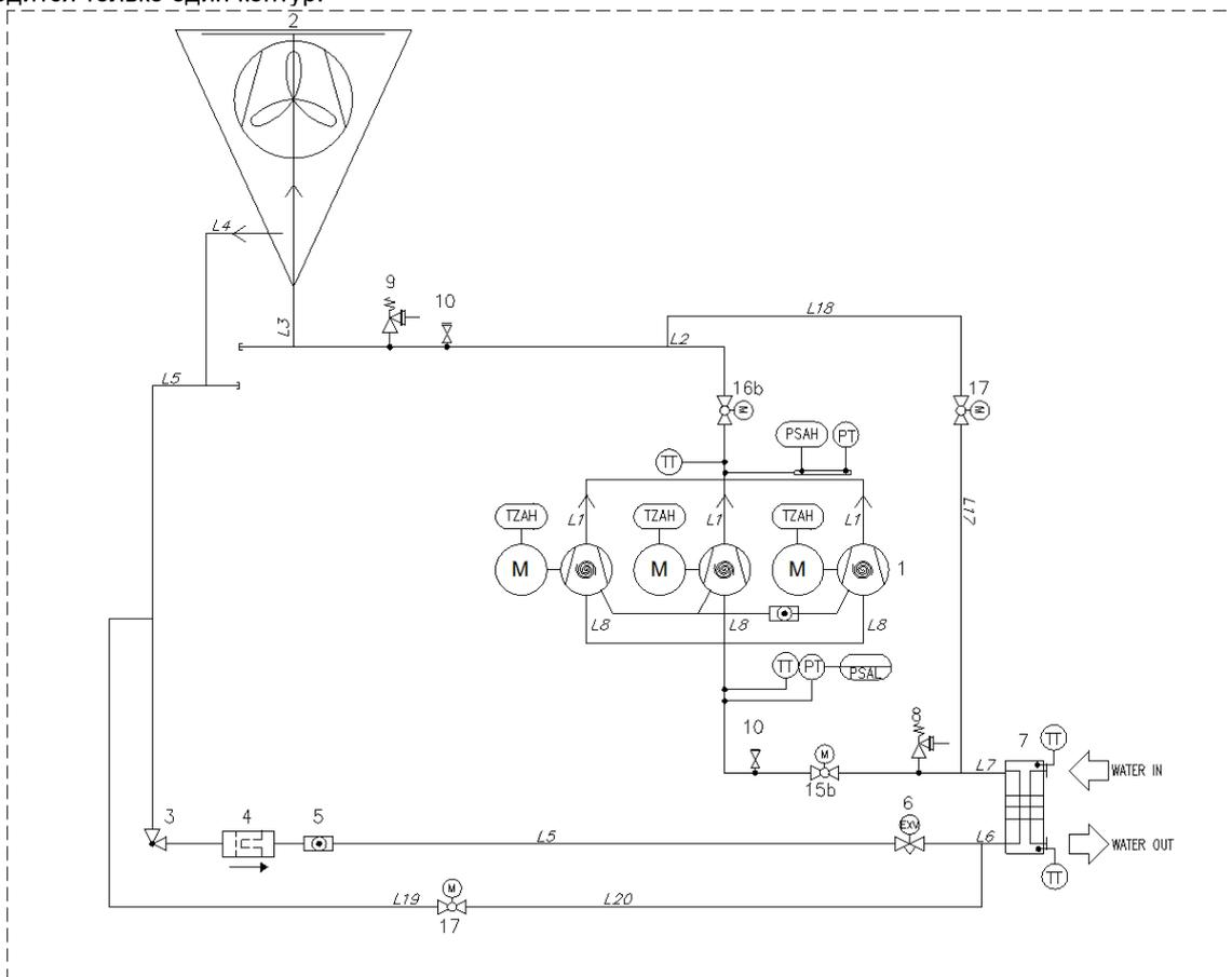
**Рис. 14. Схема контура хладагента (схема трубопроводов и КИП) для типового одноконтурного агрегата с частичным естественным охлаждением**
