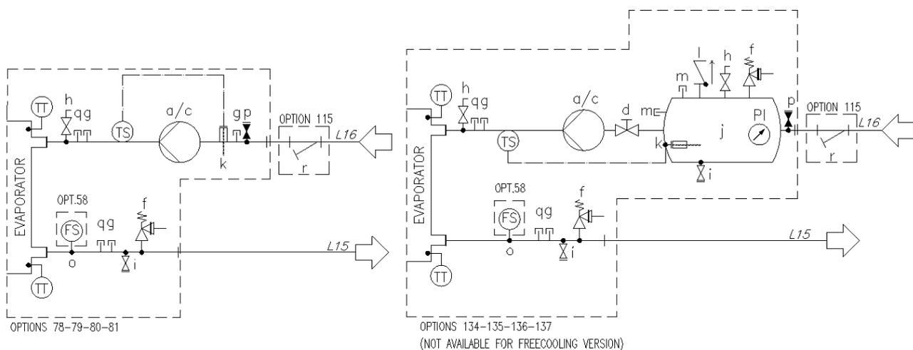
**Рис. 8. Гидравлическая схема мультисекционного агрегата (EWA Txx5B) (компл. 78-79-80-81/134-135-136-137) (макс. рабочее давление 6 бар)**
