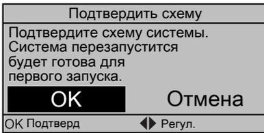
5 Интерфейс пользователя инициализируется повторно и можно продолжать установку настроек при помощи установки других доступных настроек и ввод системы в эксплуатацию.
