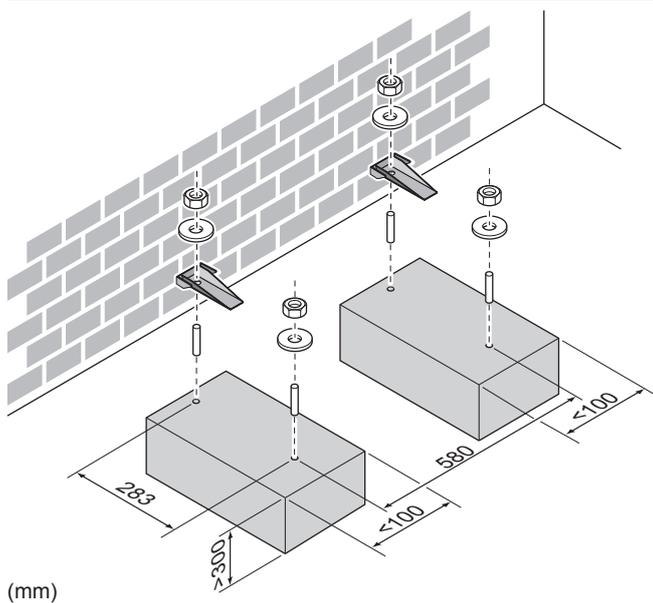
В любом случае обеспечьте зазор между блоками не менее 300 мм. Кроме того, убедитесь в том, что блок расположен как минимум на 100 мм выше предполагаемого максимального уровня поверхности снежного покрова. В этом случае рекомендуется изготовить подставку и установить на нее дополнительный комплект EKFT008CA.
