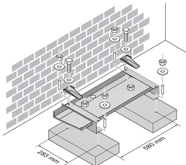
**7.3.6 Чтобы избежать опрокидывания наружного агрегата**
