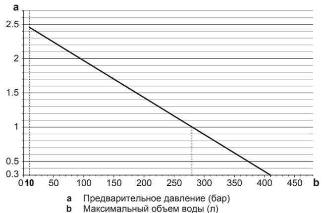
Пример: максимальный объем воды и предварительное давление в расширительном баке
