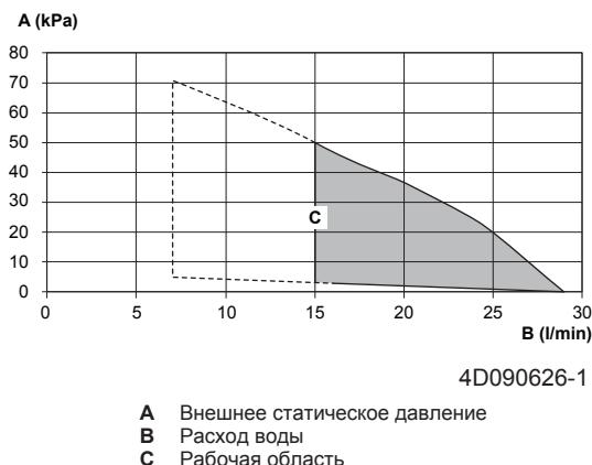
Рабочая зона расширяется в сторону меньших значений расхода только в том случае, когда блок работает только с тепловым насосом. (Не при запуске, не работа резервного нагревателя, не операция размораживания.)
