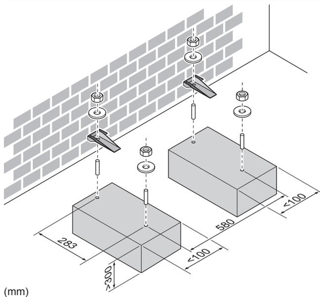
В любом случае обеспечьте зазор между блоками не менее 300 мм. Кроме того, убедитесь в том, что блок расположен как минимум на 100 мм выше предполагаемого максимального уровня поверхности снежного покрова. В этом случае рекомендуется изготовить подставку и установить на нее дополнительный комплект EKFT008CA.
