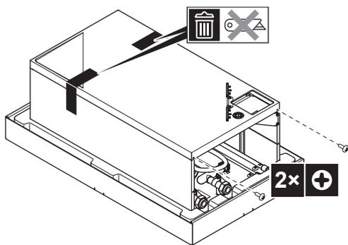
2 Отклоните нижнюю сторону передней панели вверх и снимите ее.
