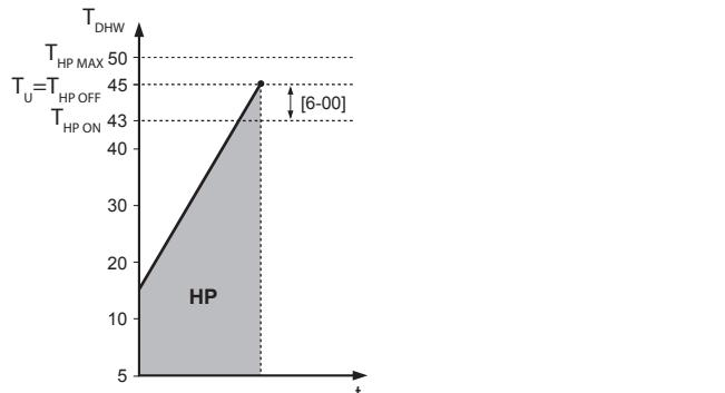
**HP** Тепловой насос. Когда нагрев тепловым насосом занимает слишком много времени, возможен дополнительный нагрев вспомогательным нагревателем
