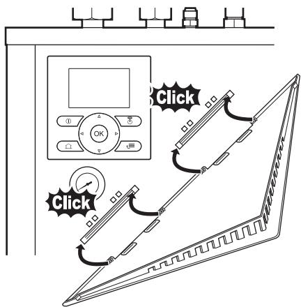
3 Установите переднюю панель на внутренний агрегат.
