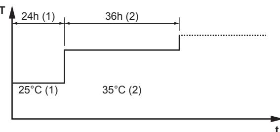
T Нужная температура воды на выходе (15~55°C)
