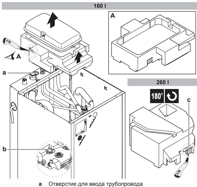
7 Установите верхнюю изоляцию, расширительный бак (в случае блока с резервуаром емкостью 180 л) и кожух.
