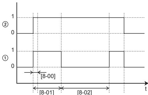
1 Режим нагрева воды бытового потребления тепловым насосом (1=активен, 0=неактивен)
