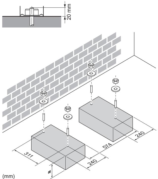
**a** 100 мм над расчетной поверхностью снежного покрова
