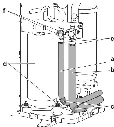
6 Если наружный блок установлен выше внутреннего, закройте запорные клапаны (f, см. выше) герметичным материалом во избежание просачивания конденсата с запорных клапанов во внутренний блок.
